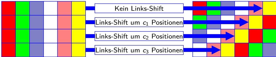
Die SHIFTRow-Operation ist eine zeilenweise Links-Verschiebung. Die Offsetwerte der Verschiebung sind abhängig von der Blocklänge:
