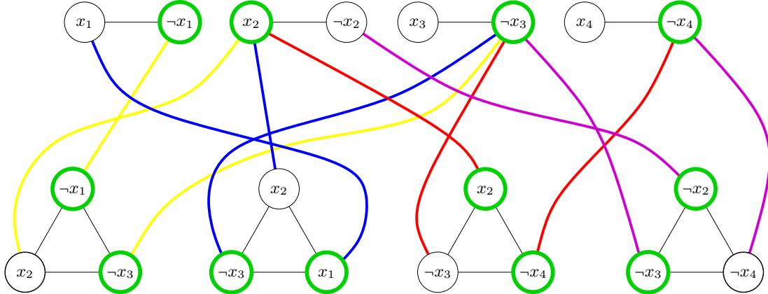
Die erfüllende Belegung  $x_1 = 0, x_2 = 1, x_3 = 0, x_4 = 0$  korrespondiert zu der in den Graphen eingezeichneten Lösung für Vertex Cover.
