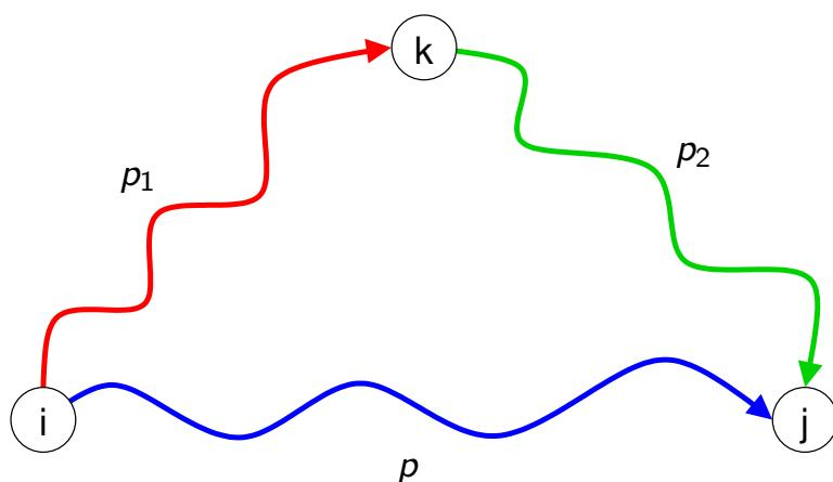
Gegeben: Pfade  $p$ ,  $p_1$  und  $p_2$  von  $i$  nach  $j$  mit minimalem Gewichten und Zwischenknoten in  $\{1, \dots, k - 1\}$
